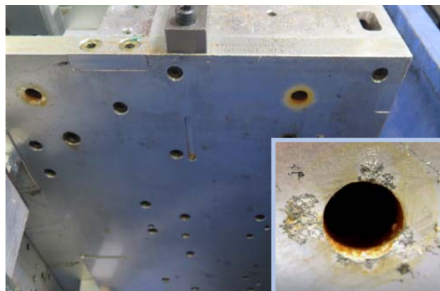
Imagen 2: molde de aleación de aluminio en el conducto de refrigeración y la corrosión por picadura. Sedimentos en primer plano.
