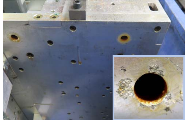
Imagen 2: molde de aleación de aluminio en el conducto de refrigeración y la corrosión por picadura. Sedimentos en primer plano.
